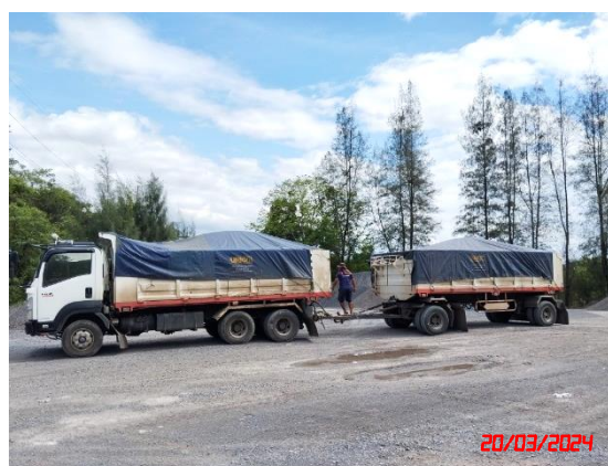
รูปที่ 17 การปิดคลุมกระบะบรรทุกด้วยผ้าใบอย่างมิดชิด
