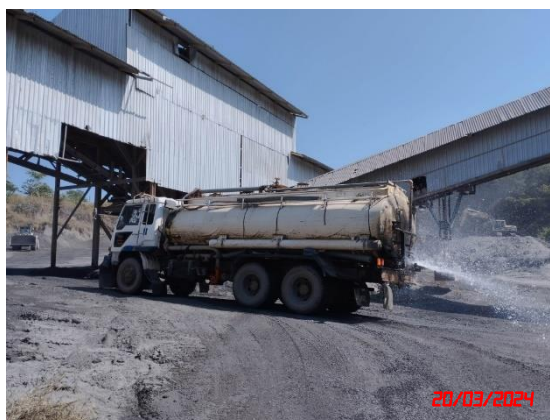
รูปที่ 10 การฉีดพรมน้ำเพื่อลดการฟุ้งกระจายของฝุ่นละอองจากกิจกรรมการขนส่งแร่
